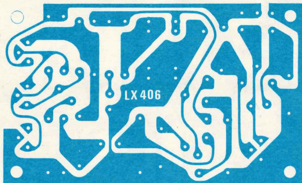
Fig. 2 Disegno a grandezza naturale del circuito stampato.
